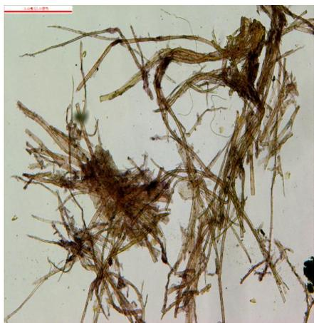
图2 显微镜下的竹纤维
