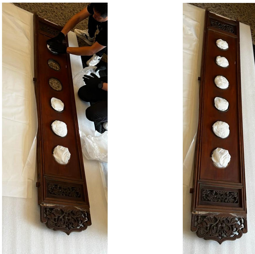
图 5 瓦当面部槽的填充
