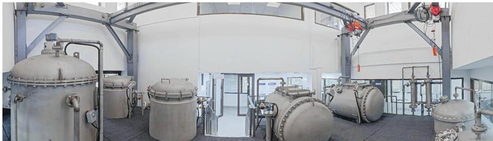
图 文献脱酸保护实验中心智慧脱酸设备
