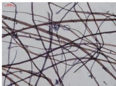
图5 故宫建筑内壁糊饰高丽纸纤维显微图(楮皮)
