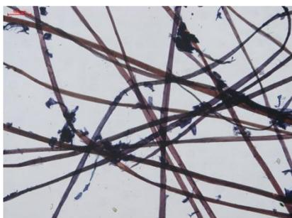
图8 韩国国会图书馆修复用韩纸纤维显微图(楮皮)
