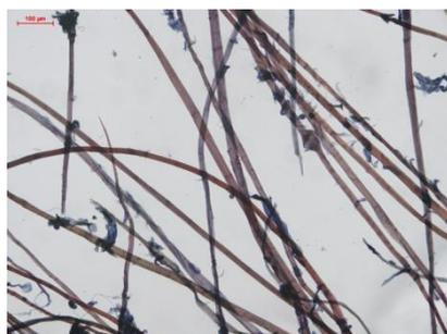
图9 平壤出产朝鲜纸纤维显微图(楮皮)
