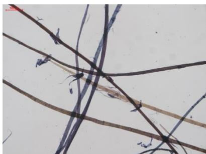
图10 北京德承贡纸坊楮皮纸纤维显微图(楮皮)
