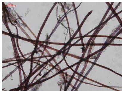
图2 宋元时期高丽佛经纸张纤维显微图(楮皮) 图3 明清高丽本古籍残页纸张纤维显微图(楮皮)
