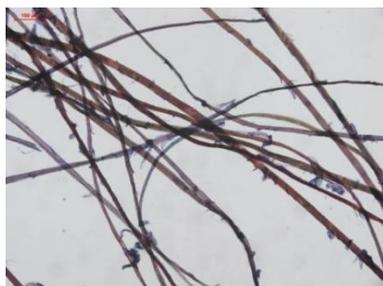
图4 故宫建筑棚顶高丽纸纤维显微图(楮皮)
