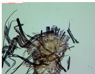
图 3 20 倍显微镜下观测《西游真詮》纸张纤维
