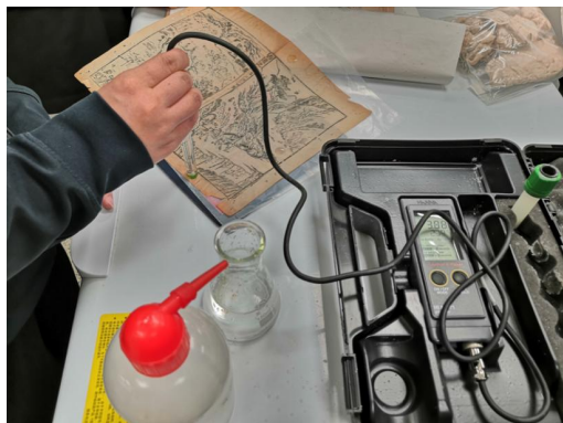
图 4 修复前检测书叶地脚处表面 pH 值
