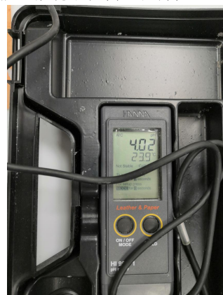
图 5 修复前检测书叶地脚处表面 pH 值显示 4.02, 酸化严重
