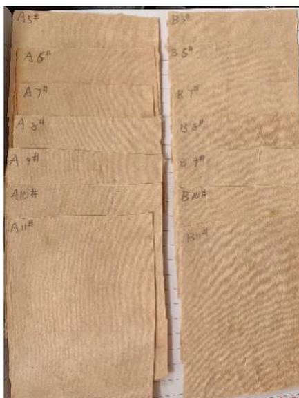
图3 实验老化的纸张小样
