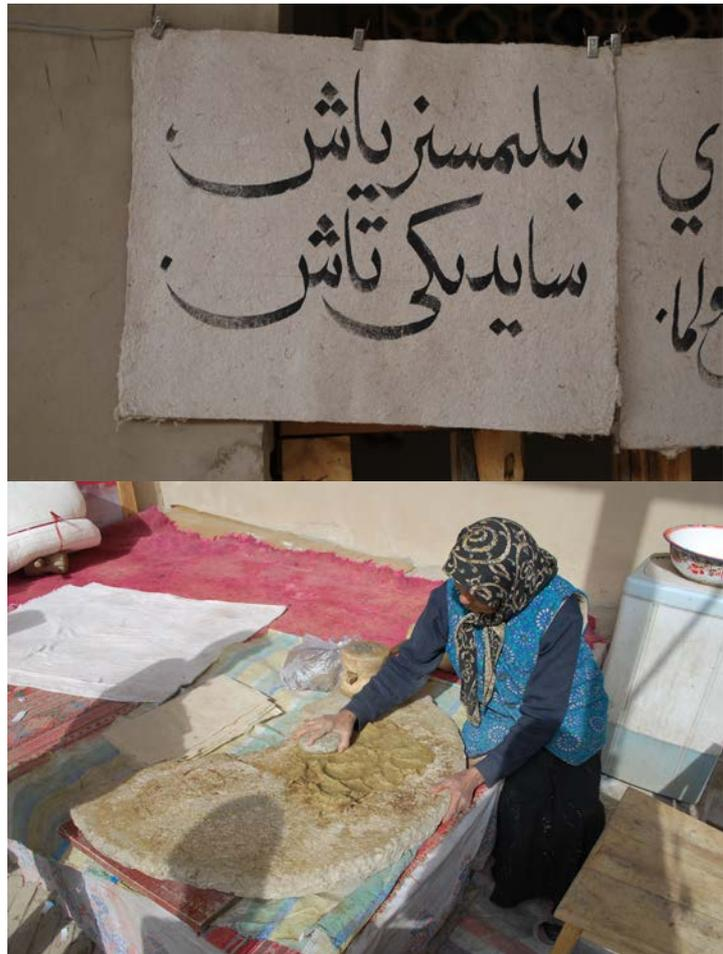
维吾尔族桑皮纸以桑树皮为原料，桑树皮有粘性，纤维光滑细腻，易于加工。制作桑皮纸时需要用到大锅，木槌，搅棍，纱框等工具经剥削、浸泡、锅煮、捶捣、发酵、过滤、入模、晾晒，粗磨而成桑皮纸，成纸呈正方形，长高各 50 厘米左右，其工艺流程如下：
