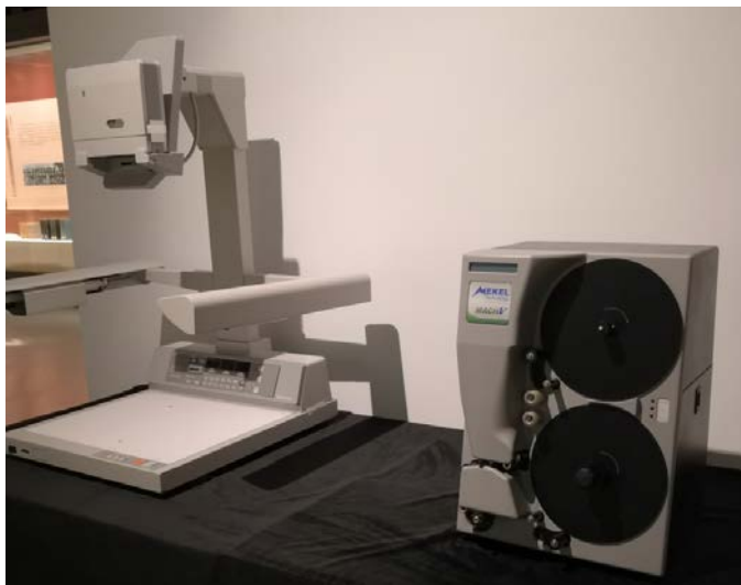
图 3 MEKEL MACH V 缩微胶片高速扫描仪, 全自动高速缩微胶卷扫描仪, 支持灰度和黑白二值, 分辨率 100dpi—600dpi, 能够将 16/35mm 缩微胶片扫描成数字图像。
