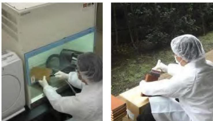
图 4 NDLE 除霉时使用的吸尘装置和户外处理的情景
